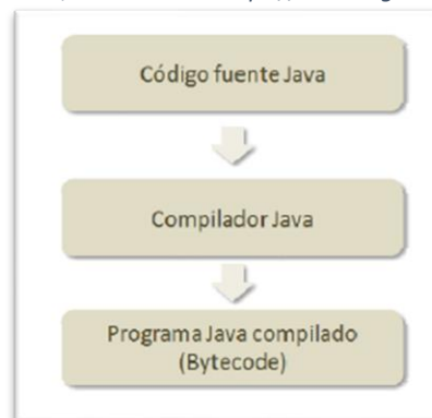
Figura 12.- El proceso de edición y compilación de JAVA, obtenido de: https://www.ingenieriasystems.com/2015/12/el-proceso-de-edicion-y-compilacion-en.html
