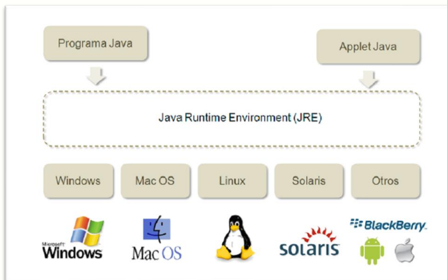
Figura 10.- Entorno de ejecución Java (Obtenido de: https://acortar.link/G6uRCG )
