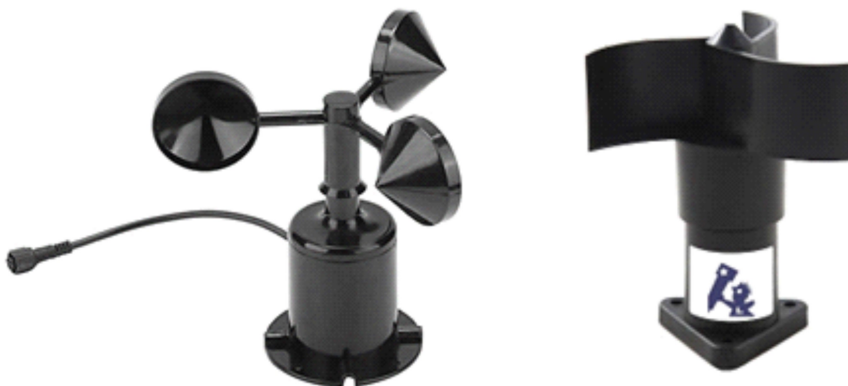
Figura 2.18 Dos tipos de sensores anemómetros
